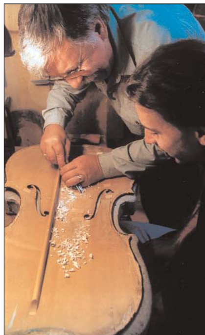
Der Instrumentenbauer Tibor Semmelweis zeigt seinen Schülern, wie ein Violoncello renoviert wird
