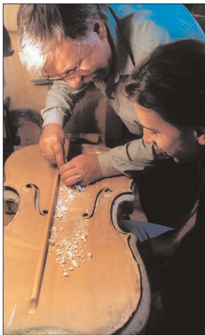
Semmelweis Tibor hangszerkészítő mester egy gordonka felújításának fogását mutatja be tanítványának
